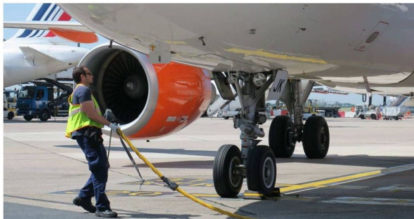
Aéroport d'Orly, ce lundi. Cet agent va brancher l'avion au réseau électrique de l'aéroport durant son stationnement plutôt qu'il ne recoure à son moteur auxiliaire polluant. Une nouveauté.
